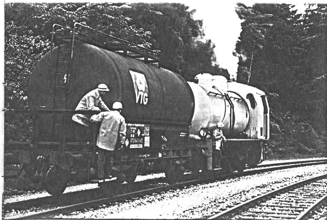
Die Wacker-Werkbahn heute: Eine der beiden Krupp-Dampfspeicherloks zieht einen VTG-Kesselwagen durch's Werk. Werkfoto Wacker
