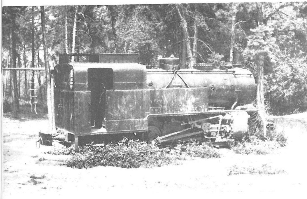
Leider nur zwei Dampflokaufnahmen liegen uns zur Bayerischen Braunkohlen-Industrie vor. Das obere Foto von Siegfried Bufe (aus: Eisenbahnen in der Oberpfalz) zeigt Lok 3 in Schwarzenfeld. Als Spielplatzlokomotive erhalten ist die als M 15 bezeichnete Schmalspurdampflokomotive, die zum Verschieben den Umsetzers in der Grube diente. Ulrich Völz nahm sie am 14.07.1983 auf dem Spielplatz in Wackersdorf auf.
