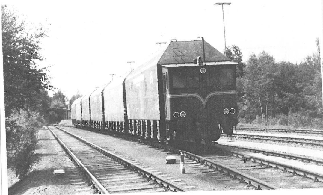
Nicht nur die Lokomotiven, auch der Wagenpark der BBI, bzw. BAG verdient Beachtung: Das obere Bild zeigt einen tausendfüßlerisch anmutenden Filteraschezug mit Steuerkabine für den Wendezugbetrieb, aufgenommen am 14.07.1983 von Ulrich Völz. Das untere Foto zeigt den 1941 gebauten Steuerwagen 71 für Grobaschezüge. Die Steuerkabine wurde nachträglich angebaut. Aufgenommen von Andreas Christopher am 03.11.1980 im Bhf. Hochbunker.
