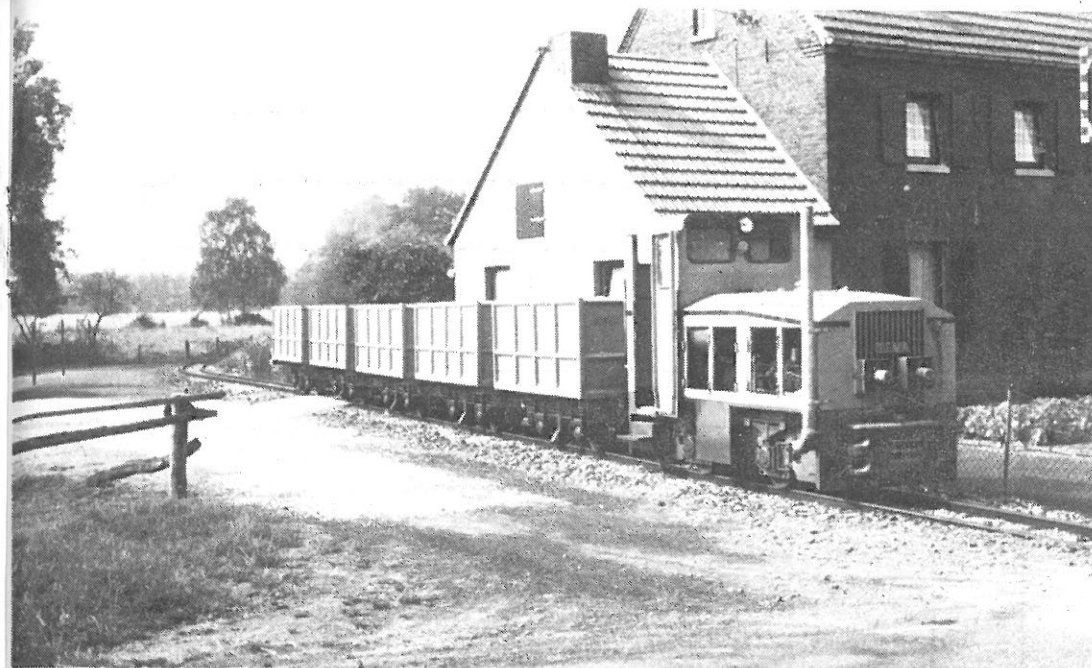
Diverse Modernisierungsversuche unternimmt die Idunahall in Schermbeck, um ihren Abbaubetrieb rentabler zu gestalten: Zum Einsatz an der Grube 1 werden Versuche mit Funkfernsteuerung unternommen, um Lok- und Baggerführer in einer Person vereinen zu können. Am 14.10.1980 wartete der Lokführer der Schöma 2208 noch auf Abschluß der Beladearbeiten. Das untere Foto zeigt Diema 2361 auf der Neubaustrecke zur Grube am 23.08.1984 am BÜ Waldaustraße/Heisterkampstraße.
