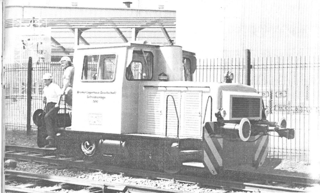
Mittlerweile prägt der Dieselbetrieb mit der modernen Schöma-Lok V 7890 den Werkbahnbetrieb der Bremer Lagerhaus-Gesellschaft, hier aufgenommen am 12.07.1982.
