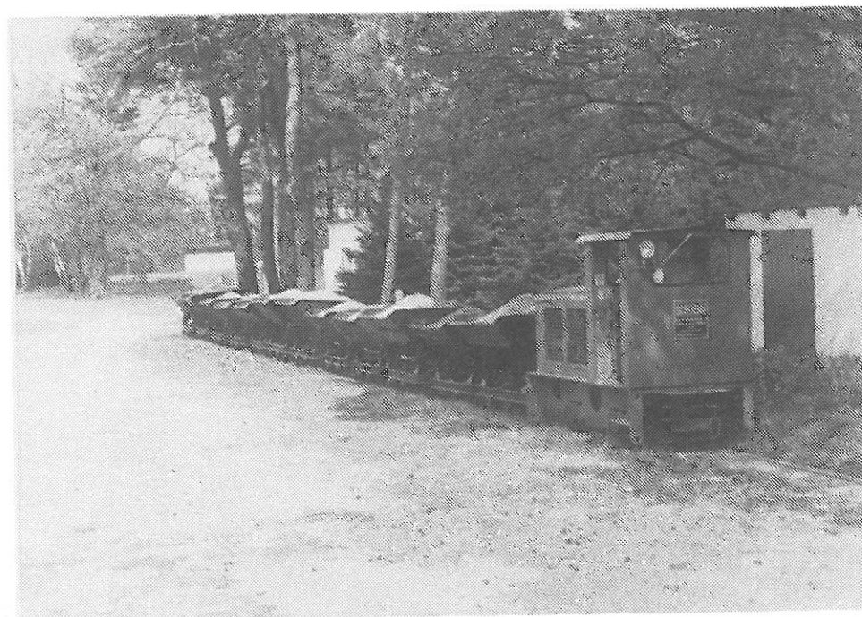
Wasserwerk Bours Berg: Ebenfalls am 16. Mai 1984 rollte die ältere Schöma-Lok (2 288/1959) kurz für einige Fotos in die Sonne - derweil machte sich die Einsatzlok mit den nunmehr beladenen Loren auf den Weg zur Kieswäsche.
