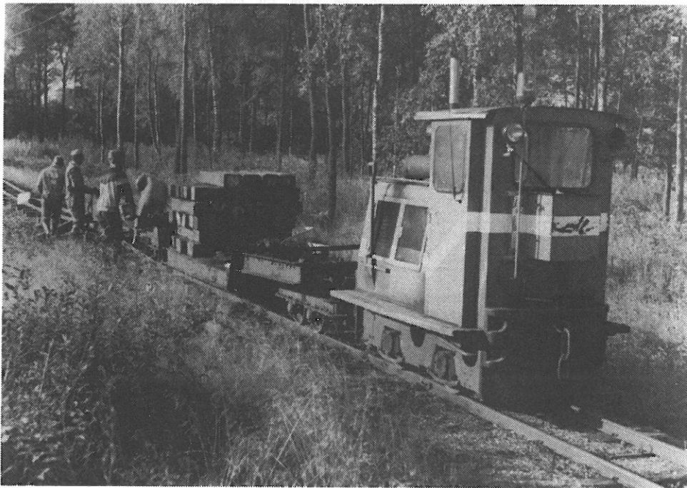
Kronmull AB, Svensköp (oben): Die Kalinin-Lok 1033 hat ihren Zug ins Abbaubiet gebracht, wo er beladen wird. Beachtenswert ist der Schwellenabstand! (11.09.90). Hasselfors, Perstorp (unten): Schöma 3406 ist mit einem Schwellentiefelader auf der Strecke (12.09.90).
