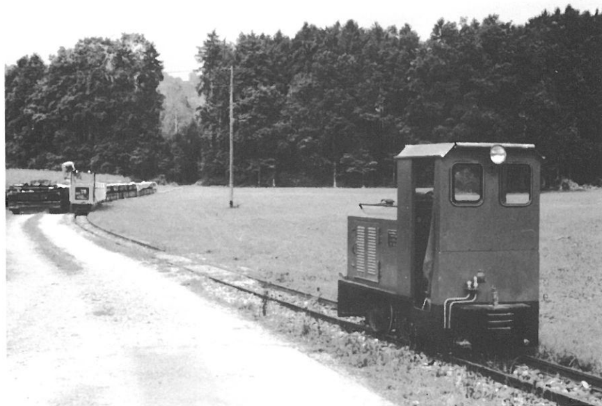
Ziegelei Schumacher, CH-Körblingen: Einsatzgarnitur auf der sehr gepflegten 600 mm-Feldbahn ist die Lok TITANUS (Schöma 5140) mit vier belgischen Hydraulikkippern, hier aufgenommen am Tunnel kurz vor der Grube (oben). Die untere Aufnahme zeigt die Reservelok (Diema 2638) an der Rückseite des Ziegelwerkes. Im Hintergrund werden gerade die Ofensteine auf dem Ofenwagen ausgetauscht (31.08.94).
