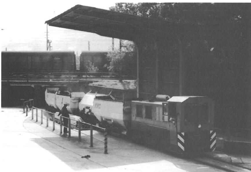
Zementwerk Hürlimann, CH-Bruppen: Diema 5146 verläßt gerade die Beladestelle. Im Hintergrund ist noch der zweite Zug erkennbar, dessen Beladung gerade begonnen hat. Die untere Aufnahme zeigt Diema 5147 an der Entladung im Werk direkt hinter der SBB-Unterquerung. Der Zug fährt langsam durch die Anlage, wobei die Wagen nacheinander entleert werden (05.09.94).
