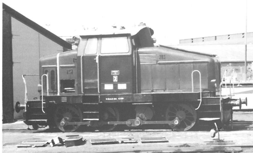
Danstål, DK-Fredriksværk: Diese seltene Loktype (DH 700 Ci) von Henschel findet sich noch heute in Form der Lok 2 (30331) bei dem dänischen Stahlwerk. Zuvor war sie im Ruhrgebiet im Einsatz (09.07.92, Thomas Nörsgaard Olesen). Leider Vergangenheit ist das Thema Schmalspurbahn im selben Werk. Das untere Foto zeigt die Lok 10 von Schöma (3064)(1972, S.A. Guldvang, Sammlung Bent Hansen).
