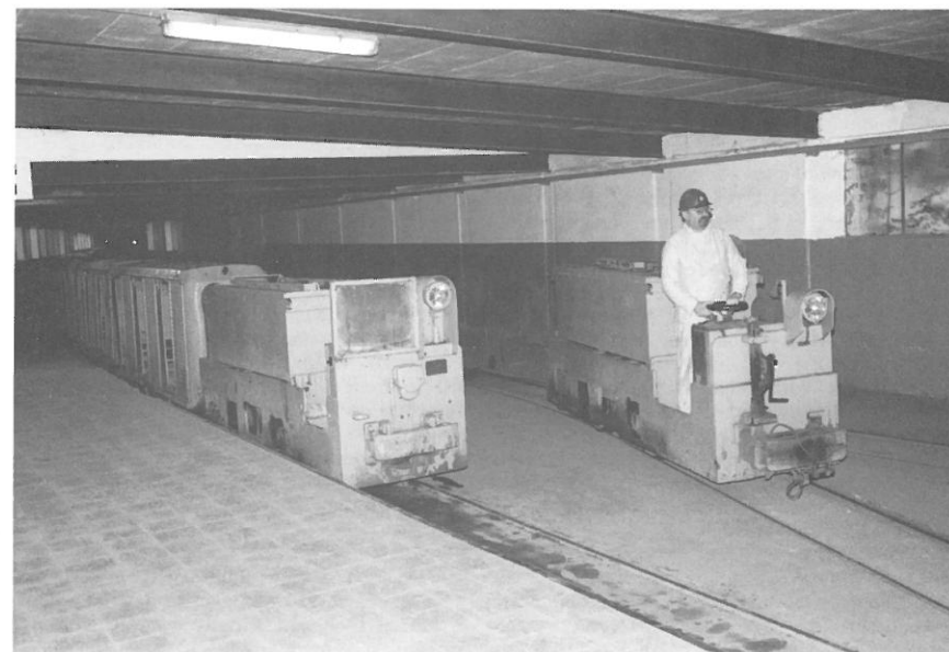
Bergbaumuseum Ramsbeck: Die Grubenbahn wird für die Besucherbefahrung mit drei baugleichen Akkuloks befahren. Der links noch erkennbare Personenzug kann über 100 Personen befördern. Das untere Foto zeigt die in der Museumshalle ausgestellte Deutz-Schmalspurlok (36747)(24.07.96).
