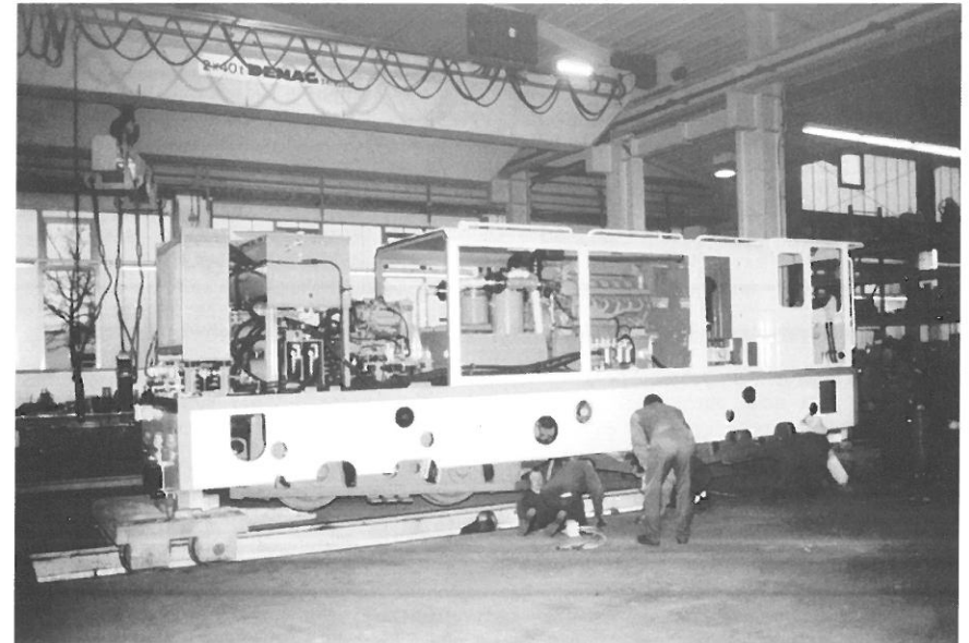
SCHÖMA, Diepholz: Tunnelloks der Superlative entstehen zur Zeit in Diepholz. Diese 52 Tonnen schwere 900 mm-Lok soll beim Bau der Metro in Madrid eingesetzt werden - hier während der Endmontage bei Schöma (17.12.96).
